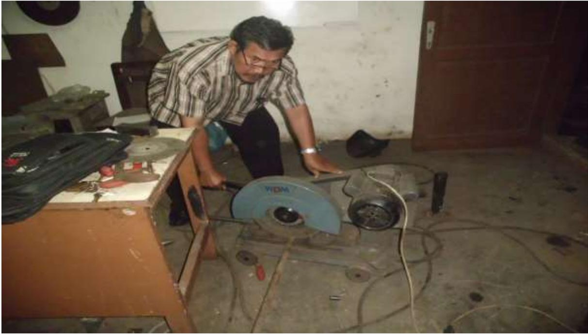
Gambar pemotongan besicor
